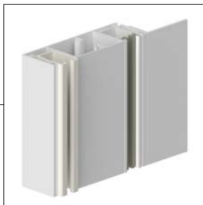
Raffstore/szúnyogháló vakolat alatti vezetősín, 32x95, 40 mm takaróprofilal
